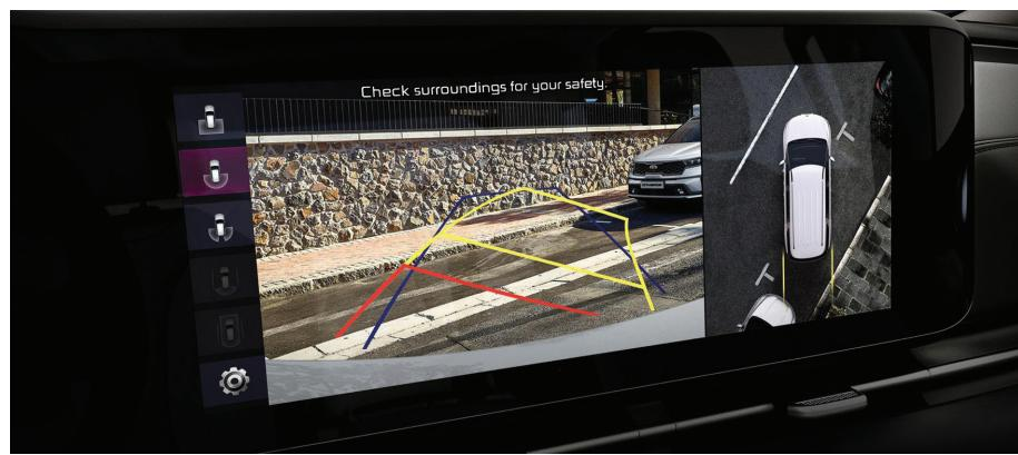
A Kia Carnival possui câmeras com visão 360° de alta definição que proporcionam uma visão completa do entorno do veículo, além de contar com sensores de estacionamento dianteiros, traseiros e laterais que oferecem maior comodidade ao dirigir.
