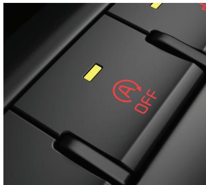
Sistema ISG (Start Stop Estendido) - Em desacelerações entre 30km/h e 0km/h, no sistema do Kia Stonic o motor à combustão é desligado por completo, economizando combustível.
