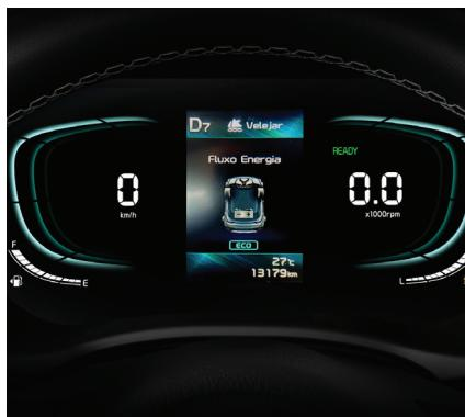
O modo "velejar" caracteriza-se pela condução com o motor desligado em condições específicas de rodagem. Quando o condutor retira o pé do acelerador, o motor à combustão é desligado de maneira imperceptível, poupando combustível.
