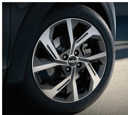
Rodas de liga leve aro 17" com acabamento diamantado e pneus 205/55R17.
