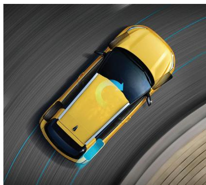
O sistema de gerenciamento de estabilidade do veículo (VSM) trabalha em conjunto com a direção elétrica, assegurando que o Stonic permaneça estável ao frear e fazer curvas simultaneamente.
