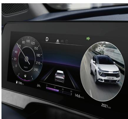
Um novo patamar de segurança é garantido através das câmeras instaladas nos retrovisores externos que captam as imagens dos pontos cegos do veículo e projetam no painel digital de instrumentos.
