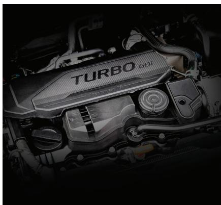
O Sportage é equipado com motor 1.6L Turbo Smartstream com Injeção Direta (T-GDI) híbrido de 48V, à gasolina, capaz de gerar 180 cv a 5.500 rpm e torque de 27 kgf/m.
