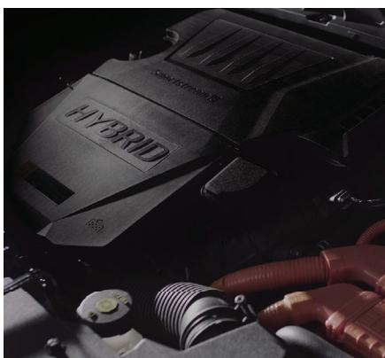
O Kia Niro está equipado com motor Kappa PE 1.6L híbrido HEV com Injeção Direta (GDI), 4 cilindros, à gasolina, capaz de gerar 141 cavalos de potência combinada e torque de 27 kgf/m.
