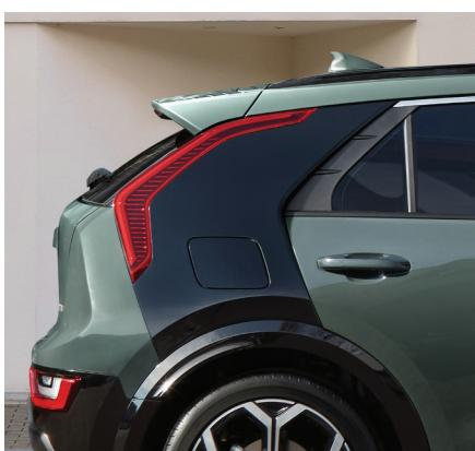
O design da coluna C destaca o perfil do carro, que pode ter acabamento em outra cor, diferente da carroceria. Para evitar a pressão estática, a coluna C aerodinâmica possui uma abertura para permitir a passagem do ar.
