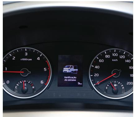
O Bongo 4x4 possui painel dianteiro com detalhes na cor cinza e odômetro digital com medições parciais A e B e conta-giros, além de computador de bordo e indicação do nível de ureia, com controle no volante.
